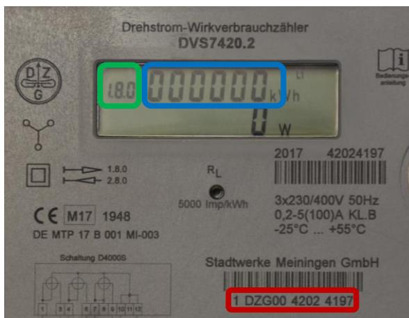
Diese digitalen Zähler haben mehrere Zählwerke, deren Zählerstände rotierend in der oberen Displayzeile angezeigt werden. Hinter dem Zählerstand wird die Einheit kWh (für Kilowattstunden) angezeigt.
